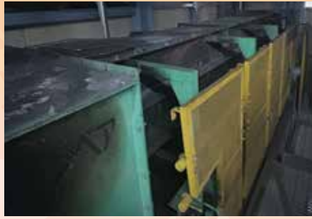
↑今回の火災で焼損したコンベア↓
