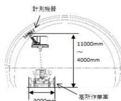
2台の計測装置 (合計4本のハンマーで打撃可)
