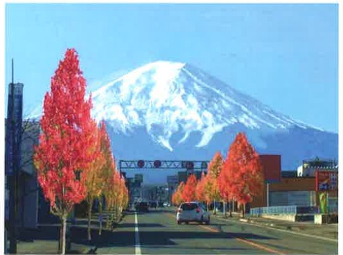
◎整備イメージ (CG)：電線等地中化、看板類の制限、街路樹の導入。現状の街路樹は、市の木であるシラカバですが、シラカバは、高原の気温の低いところを好む落葉樹で、成長が遅く、また樹形も横に広がり整形を保つのが難しい樹種です。電線類を地中化し、看板を下げ、街路樹を樹形と紅葉の美しいアメリカフウに変えて、演出を行った例です。
